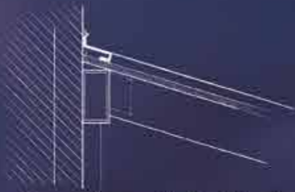
Firstenanschluss mit Kantblech und Dichtklebes
